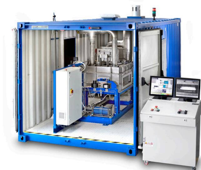
Banco per il collaudo con azoto della raccordatura
