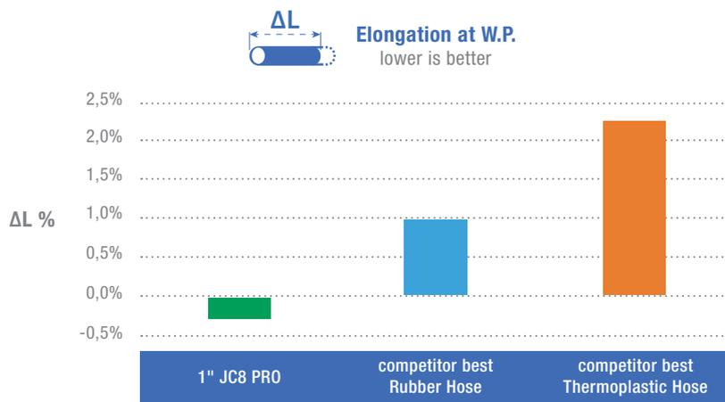
Il test è stato eseguito secondo ISO 1402. I risultati sono espressi come variazione percentuale di lunghezza rispetto alla lunghezza del tubo non in pressione.
