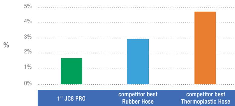
Il test è stato eseguito secondo ISO 1402. I diametri esterni sono stati misurati in due direzioni ortogonali prima e dopo la pressurizzazione fino alla pressione di esercizio. I risultati sono espressi come variazione percentuale delle medie delle misurazioni.
